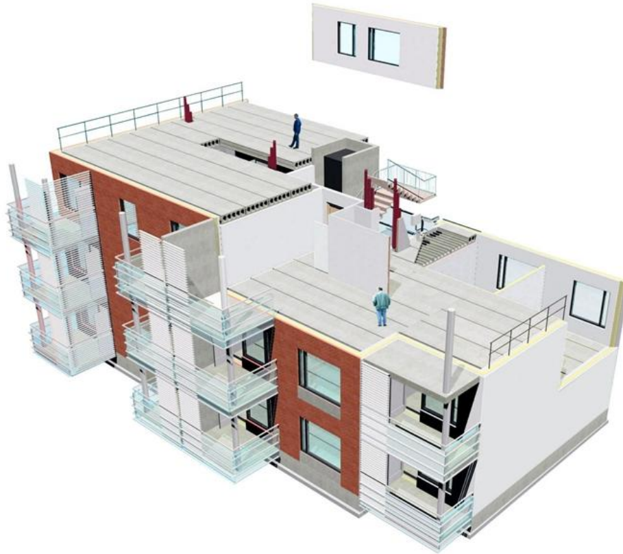
Kuva 15. Kantavat väliseinät ja laatat järjestelmän periaatekuva (Elementtisuunnittelu, 2012).
