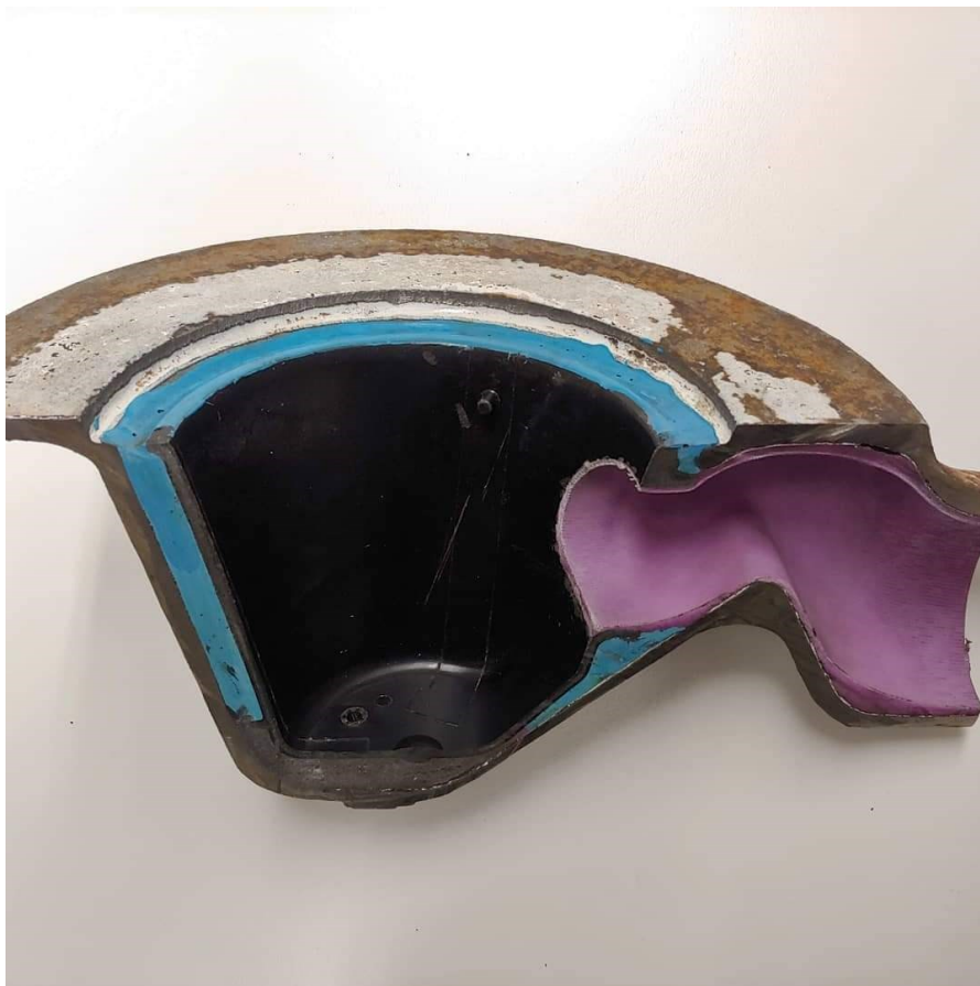
Kuva 18. Lattiakaivo halkaistu asennuksen jälkeen, insertiasennus [13]
