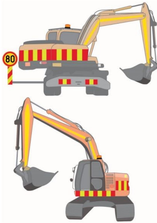
Kuva 3. Kaivinkoneen näkevöittäminen (Väylävirasto 2020, 34)
