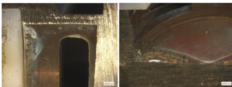
Kuva 4. Näytteen 4 (keittiön hana vuodelta 2012) sisäpinnalla ei havaita sinkinkatota, mutta pinnalla on jonkin verran saostumaa. (Eurofins Expert Services Oy 2020)
