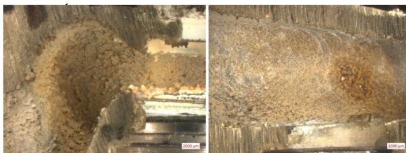
Kuva 5. Näytteen 11 (suihkuhana vuodelta 2002) sisäpinnalla on tyypillinen saostumakerros, joka Rauman vedestä kiinnittyy messingin pintaan. Sinkinkatota tässä näytteessä ei ole tapahtunut. (Eurofins Expert Services Oy 2020)
