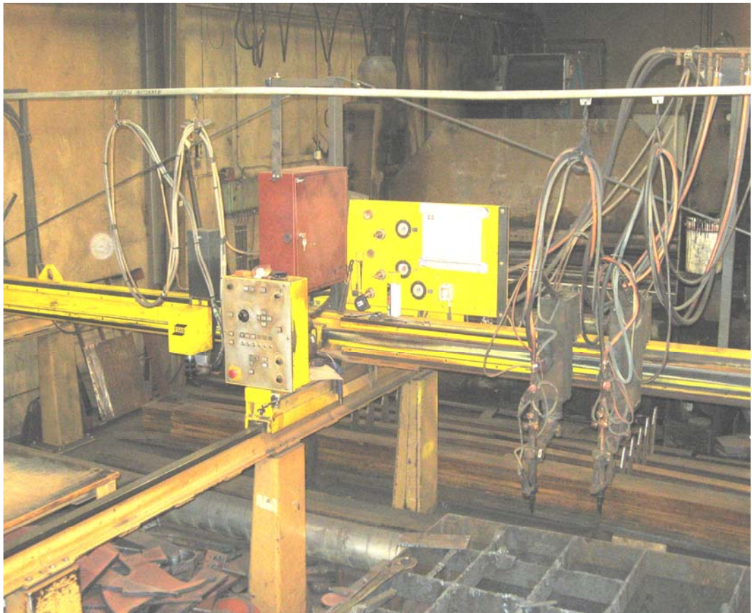
KUVA 3. Polttoleikkaus vaunusta ja letkunipusta
