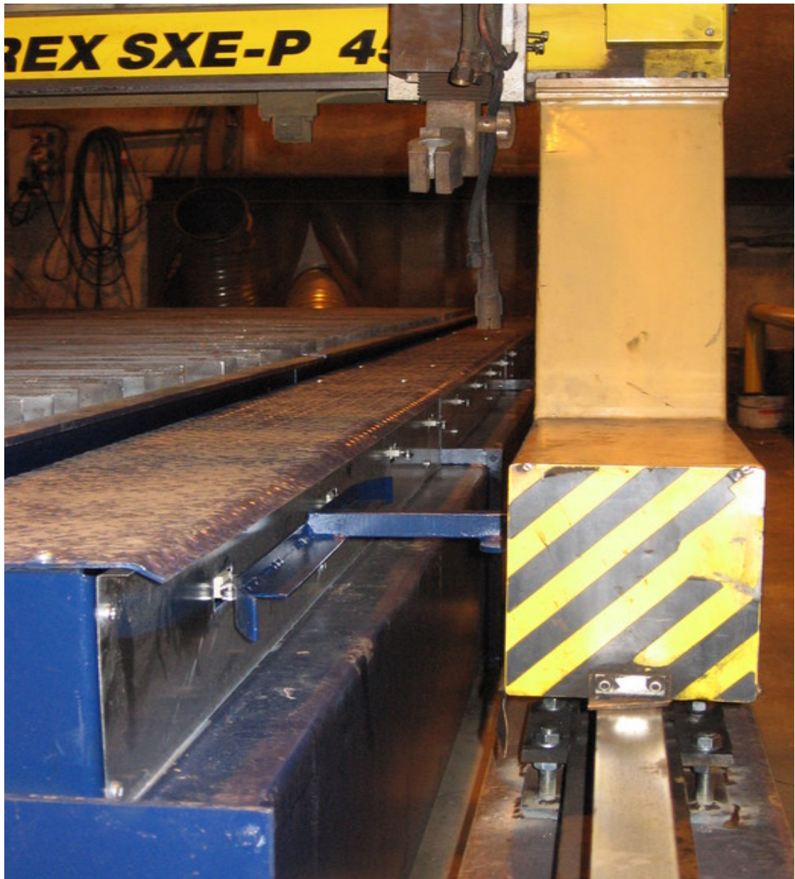
KUVA 8. Poistoimurin läppien ohjaus.
