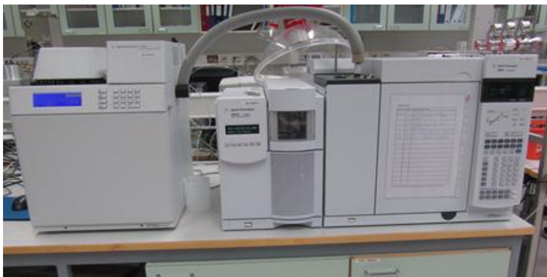
KUVA 5. Vasemmalta oikealle Agilentin G1888-headspace-näytteensyöttäjä, 5975C-massaspektrometri ja 7890A-kaasukromatografi. Kaasunsiirtolinja menee HS-näytteensyöttäjältä kaasukromatografille. (Kuva: Emilia Viitikko 2012)
