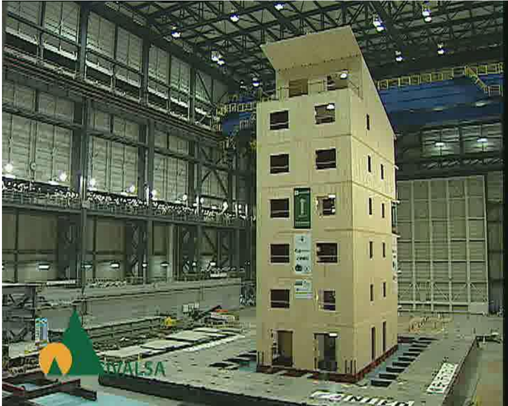
Kuva 7. Seitsemänkerroksisen CLT -kerrostalon seisminen testaus E-Defense laboratoriossa Japanin Miki:ssä. (Ceccotti, A. FPInnovations)
