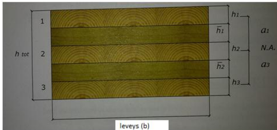
Kuva 8. CLT-elementin mitoittamisessa käytettävät symbolit (FPInnovations 2011d.)
