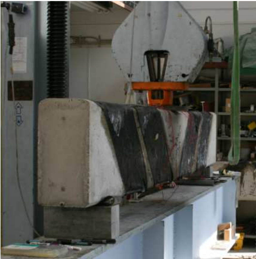
Kuva 17 Hiilikuidulla vahvistettu palkki valmiina kokeistukseen
