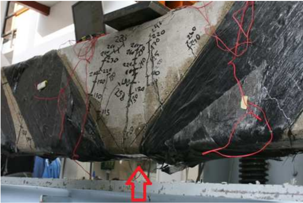
KUVA 43 Vahvistettu palkki murtui hiilikuitutangon liimauksen pettäessä.
