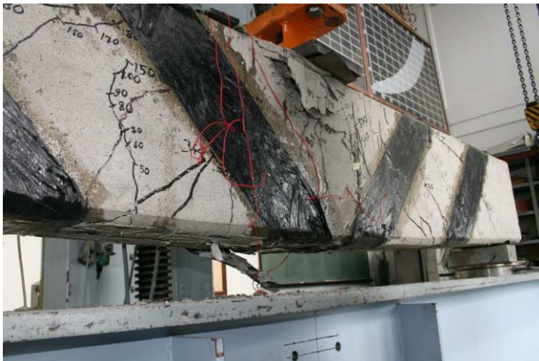
KUVA 46 Korjatun palkin puristumurtuma
