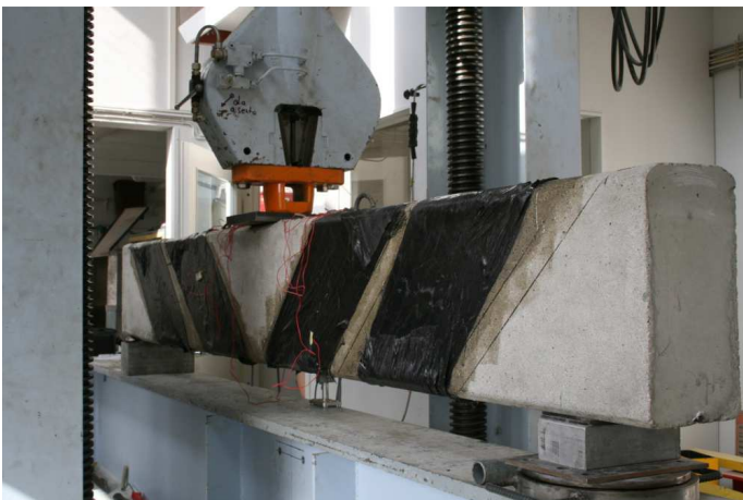
KUVA 41 Vahvistettu palkki koepuristuksessa
