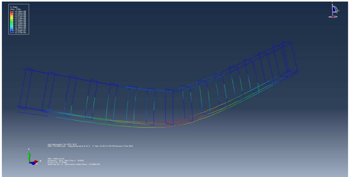
KUVA 25 Vahvistetun palkin jännitykset 285 kN pistekuorman kohdalla
