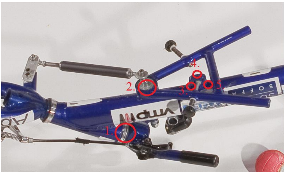
KUVIO 21. Vanhan kelaustuolin ohjauksen kiinnitysreikien paikat
