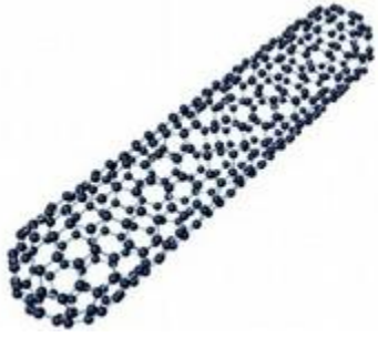
KUVIO 7. Hiilinanoputken perusrakenne (Jyväskylän yliopisto 2007)
