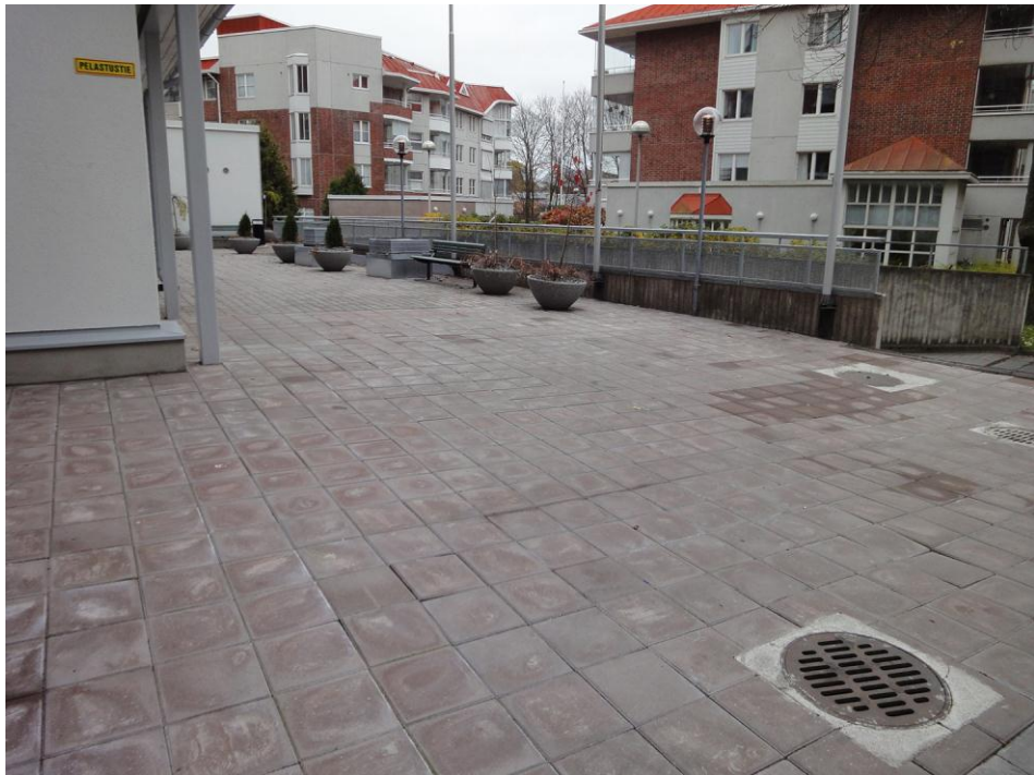
Kuva 15. Kaivojen läheisyydessä kantavuus ei ole riittävä tukijaloille. Alue on merkitty pelastustieksi.
