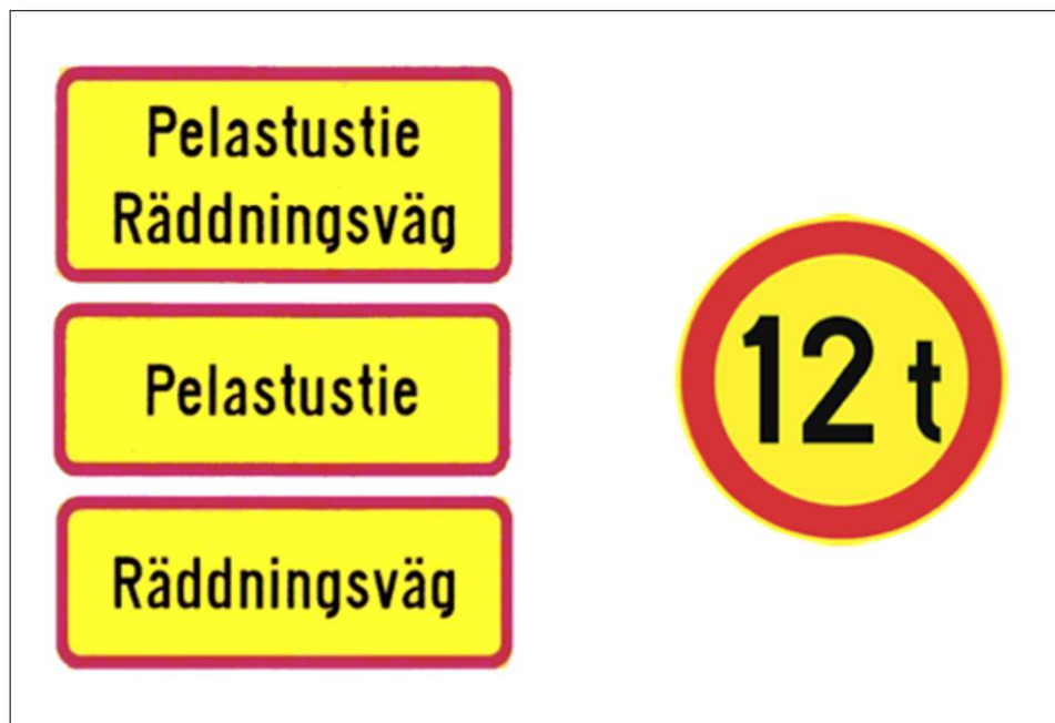
Kuva 1. Pelastustiemerkin vaihtoehdot ja painorajoitusta ilmaiseva merkki (Varsinais-Suomen Pelastuslaitos 2011).
