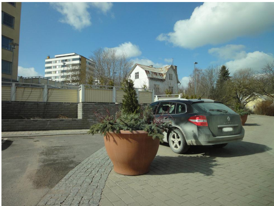
Kuva 26. Auto ja ruukuissa olevat istutukset ovat nostoalueella, estäen pelastustien suunniteltua käyttöä. Kuva Paraisilta.
