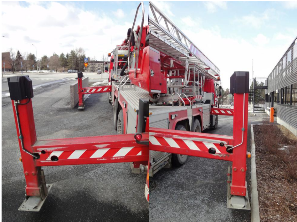
Kuva 13. Minimimitoituksella pelivaraa ei ole. Kuvassa sama auto eri puolilta nostoalueeksi mitoitettulla alueella. Vasemmalla puolella etupäässä graniittimuuri ja oikealla istutusalueen reunakiveys rajaavat käytettävää aluetta.
