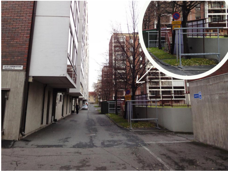
Kuva 24. Pelastustiemi on sijoitettu liian kauas liittymäkohdasta. Lisäksi sen edessä on näköesteitä. Kyseinen kohde ei muutenkaan ole suositeltava pelastustien esimerkki.
