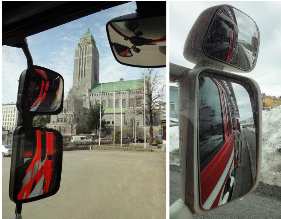
Kuva 30. Apukuskin paikalta otettu esimerkki näkyvyydestä taaksepäin.
