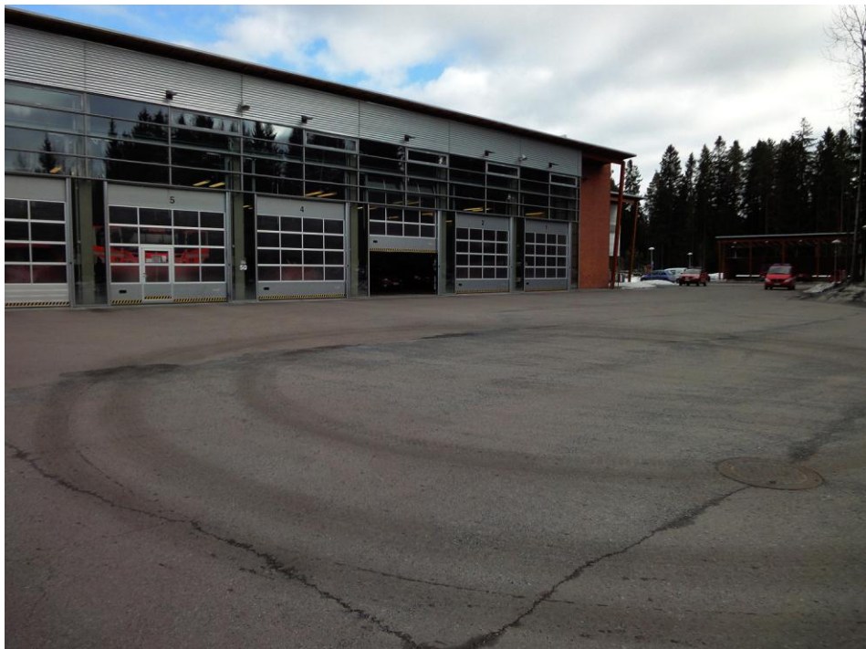
Kuva 12. Nostolava-auton kääntösäde renkaanjälkinä paloaseman pihalla Nokialla. Halkaisija on noin 16 metriä. Auton pituus oli reilut yhdeksän metriä. Peränylitys seuraa suunnilleen etupyörien linjaa, eli ulointa kehää.
