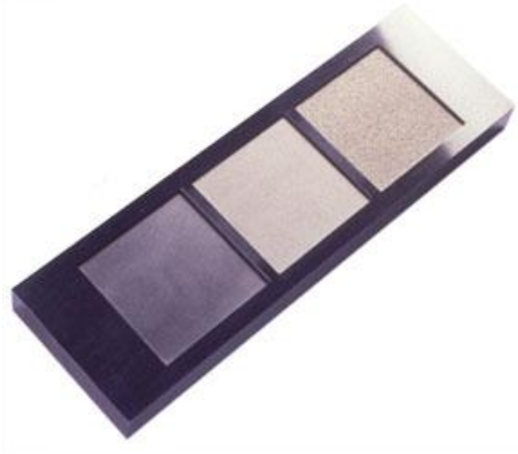
KUVA 11. Kipinätyöstettyjä pintoja (Hautamäki 9.4.2012, sähköpostiviesti)
