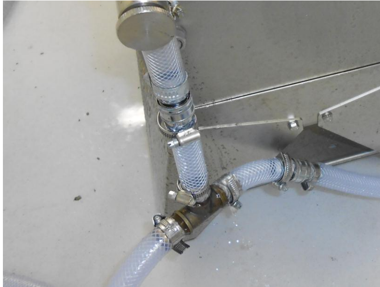
Kuva 16. T-liittimen kautta vesi virtasi kahdesta letkusta suodattimelle. (Kuva: Hannu Piironen.)
