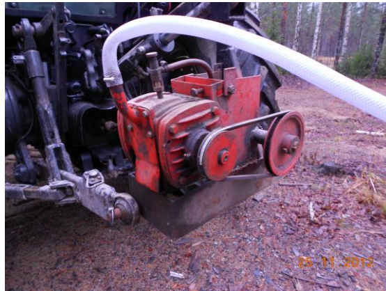
Kuva 6. Traktorikäyttöinen tyhjiöpumppu Hertell 1000 B toimi imun lähteenä. (Kuva: Hannu Piironen.)
