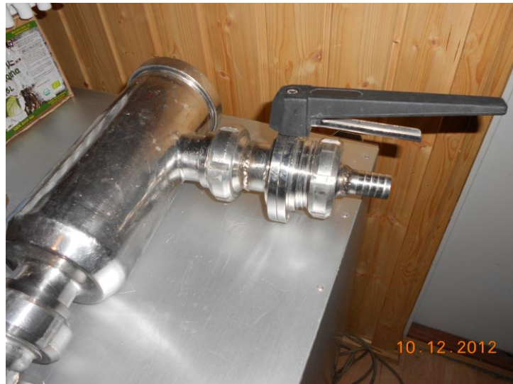
Kuva 7. Pöydällä ovat tilatankin karkea suodatin, pallosulkuventtiili ja hitsattu sovite letkulle. (Kuva: Hannu Piironen.)
