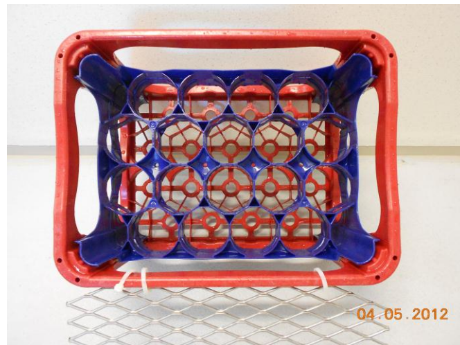
Kuva 21. Korin pohjaan porattiin pullojen kohdalle reikiä veden poistumiseksi. (Kuva: Hannu Piironen.)
