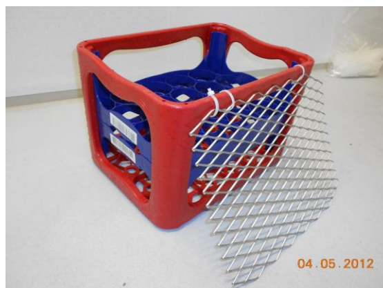
Kuva 13. Desinfiointikori 18 pullolle rakennettiin Alkon korista. (Kuva: Hannu Piironen.)
