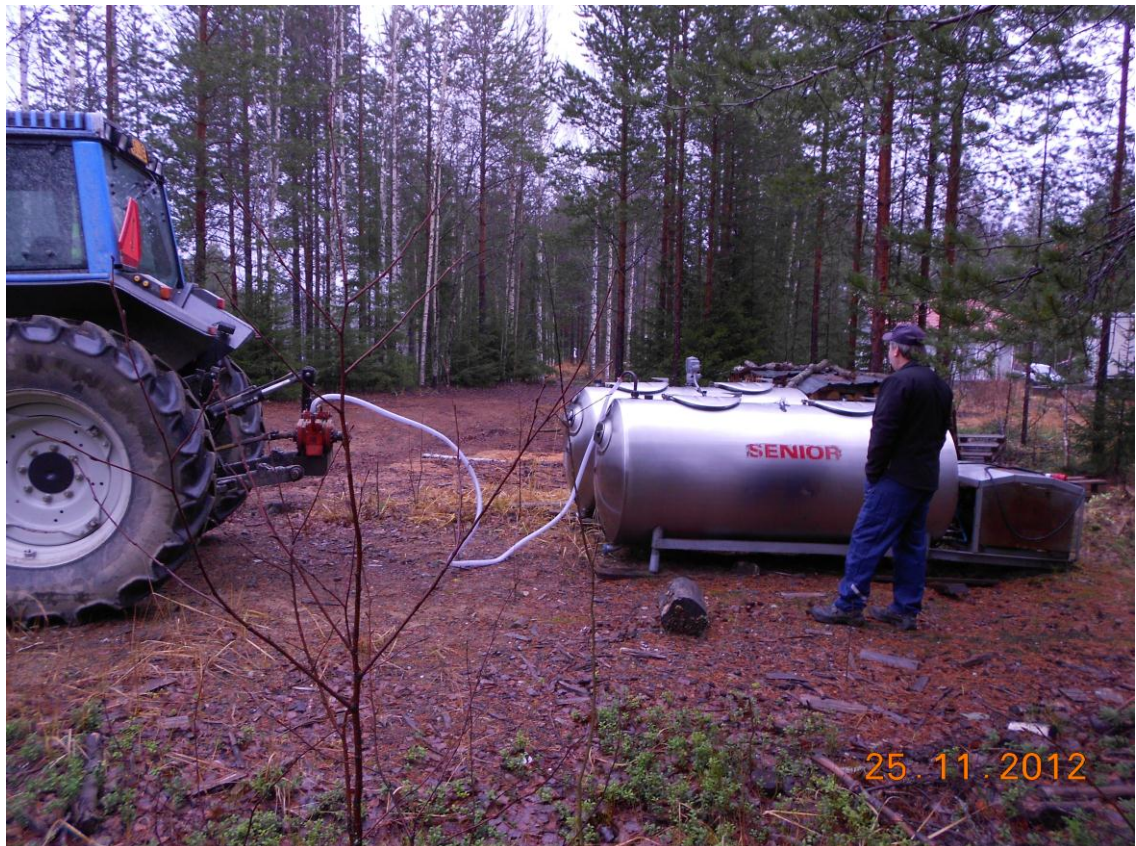
Kuva 5. Kuvassa ovat nelivetotraktori, tyhjiöpumppu, alipaineletku ja tilatankki. Kuvasta uupuu peräkärri ja imuletku. (Kuva: Hannu Piironen.)
