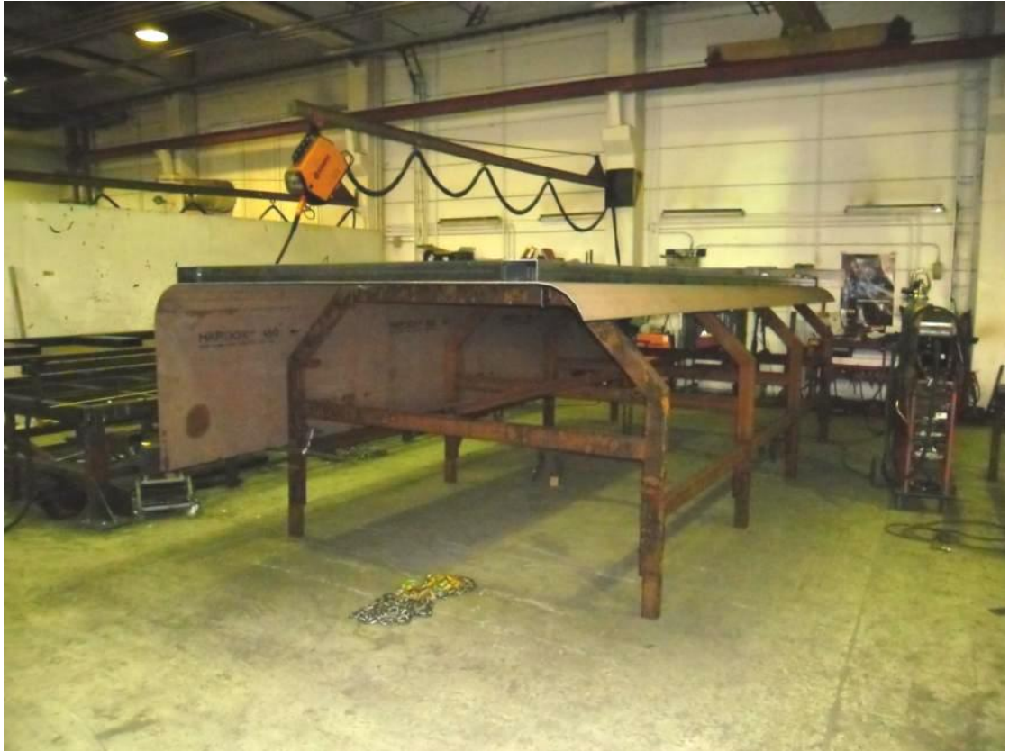
KUVA 6. R200- lavan laidan yhdistäminen pohjaa jigien päällä. Valokuva Ilkka Juutilainen 2012
