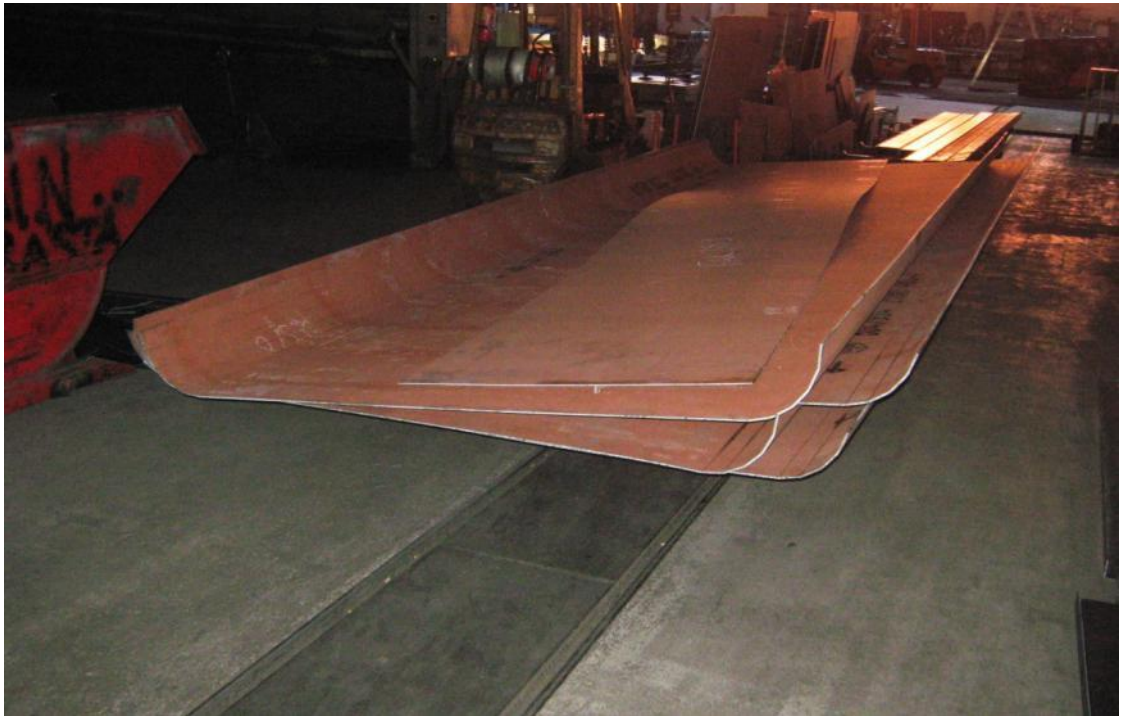
KUVA 15. Särmätyjä lavan pohjalevyjä kuljetusradan vaunussa. Valokuva Ilkka Juutilainen 2012
