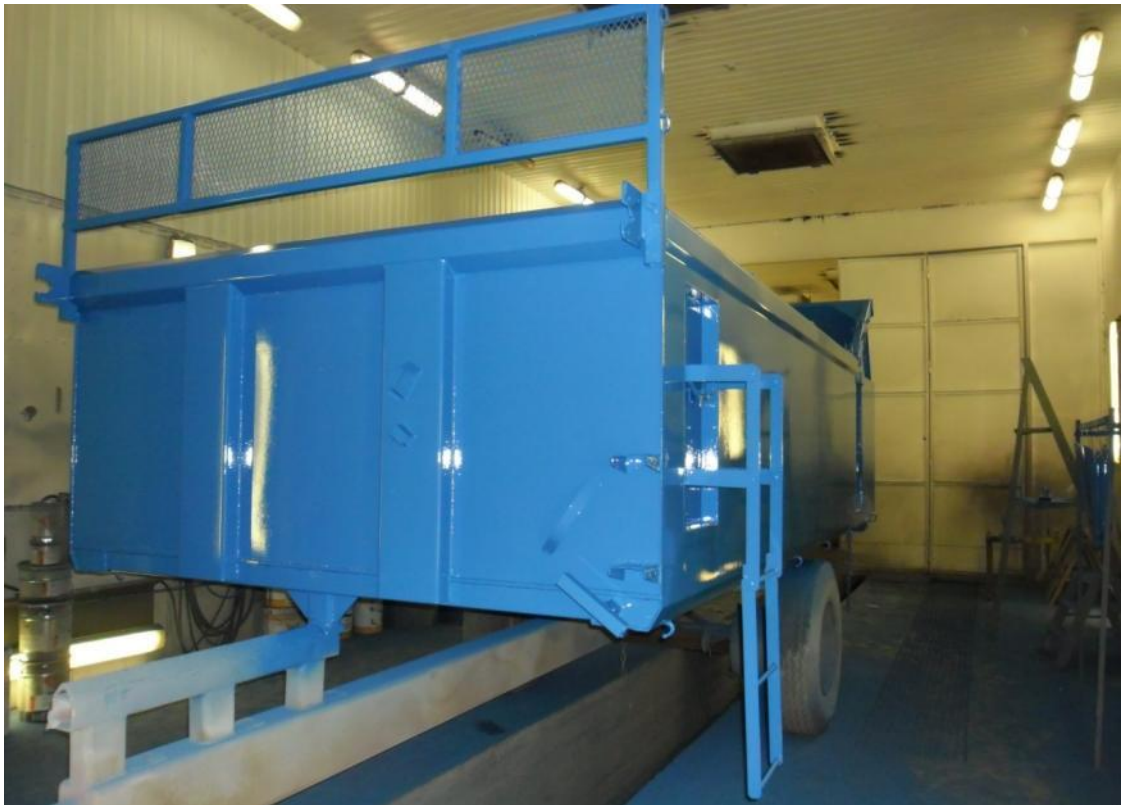
KUVA 8. Sileälaitainen lava maalaukammiossa maalattuna. Taustalla näkyy maalaukammiot jakava väliovi. Valokuva Ilkka Juutilainen 2012
