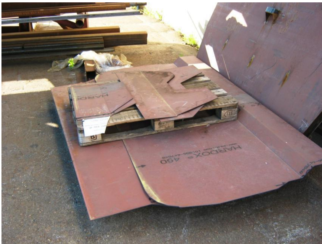
KUVA 14. Valmiiksi muotoon laser-leikattuja ja särmättyjä Ultra Light -lavan osia. Valokuva Ilkka Juutilainen 2012
