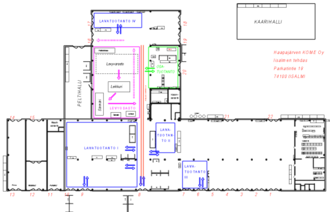
KUVA 10. Layout-piirros levyosastolla tapahtuvista siirroista. Piirros Ilkka Juutilainen 2012
