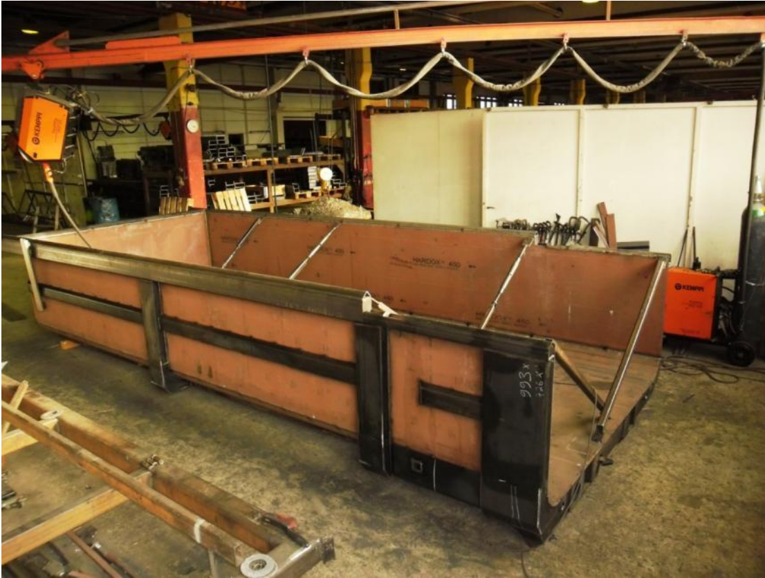
KUVA 7. Lava hitsattuna ennen perälaudan valmistamista. Valokuva Ilkka Juutilainen 2012
