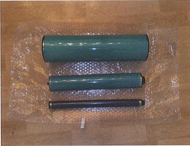
Kuva 8. Erikokoisia kopiokoneen rumpuja, alhaalta ylöspäin rummut ovat laitemallien Aficio 2018, Aficio 3045, Aficio 2060.
