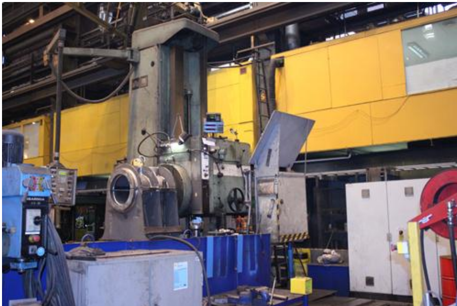
Kuva 6. Polttohallin avarruskone BFP 130/5
