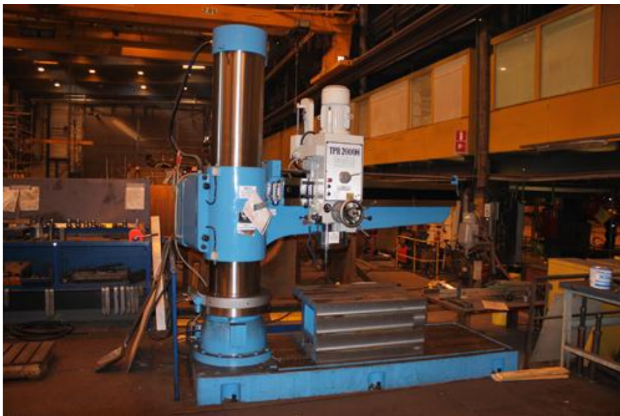
Kuva 5. Polttohallin säteisporakone Tailift TPR 2000H
