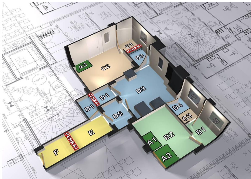
KUVA 2. GMP:n mukaisten puhdastilojen pohjakuva (Puhdastilakoulutuskeskus 2012).
