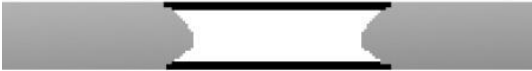
KUVA 5. Kylmäjuoksu (Meskanen ym. 2010, 7)
