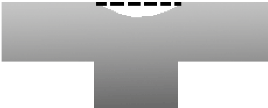
KUVA 8. Imupainauma seinämien risteyskohdassa (Meskanen ym. 2010, 14)
