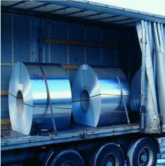
Kuva 40. Erikoisrakenteinen perävaunu kelojen kuljetukseen (17)
