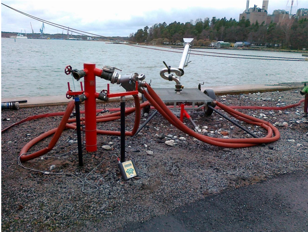
KUVIO 9. Lavettivesitykki ja virtausmittari kiinnitettynä palopostiin 1
