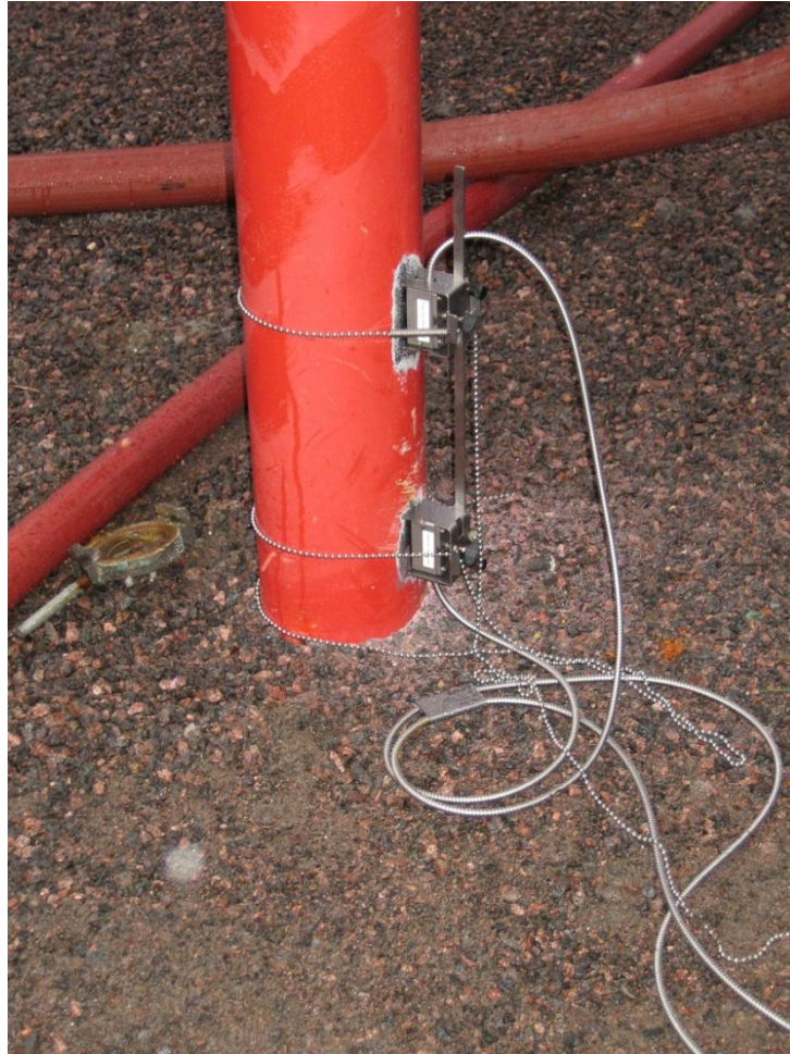
KUVIO 7. Virtausmittarin anturit kiinnitettynä palopostin runkoon
