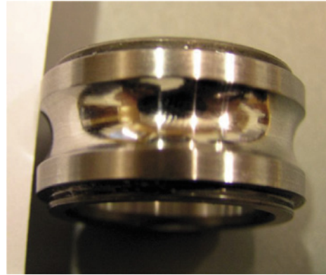
Kuva 9. Laakerin sisäkehälle on lyöty jälki /5/
