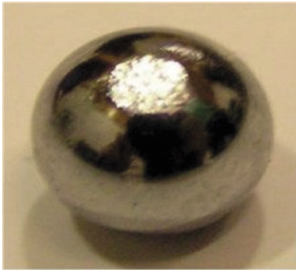
Kuva 8. Laakerin kuulan pinnasta on viilattu osa pois /5/
