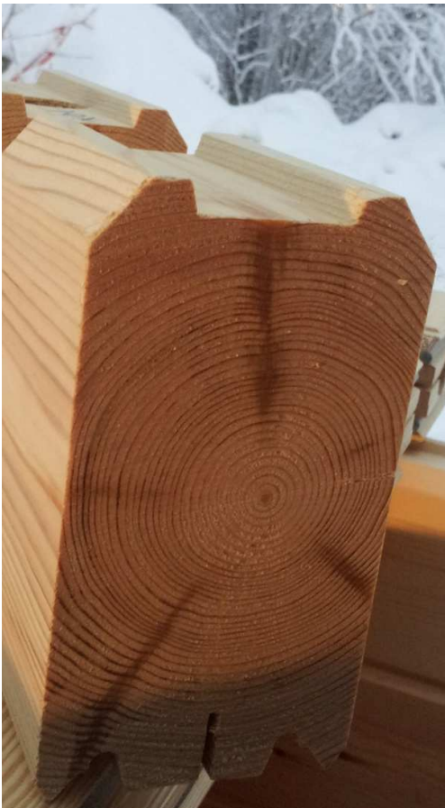
KUVA 1. Lamellihirsi 95x170 ja eristeet
