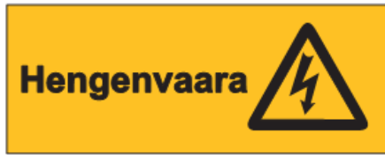
Kuva V.4 Varoituskilpiä, joissa on kilven ja tekstin yhdistelmä: Hengenvaara-tekstillä varustettua kilpeä voidaan käyttää esim. pylväissä, sähköalueen aidoissa ja sellaisten tilojen ovissa, joissa on kosketussuojamattomia osia. Jännitteinen tekstillä varustettua kilpeä voidaan käyttää esim. käyttöön otetuissa keskuksissa, joissa on vaarallinen jännite.
