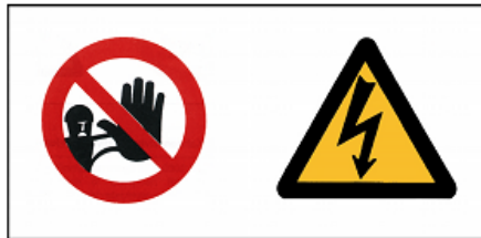
Kuva V.5 Kahden kilven tai kilven ja tekstin yhdistelmä, joita voidaan käyttää esim. sähkötilojen ja sähkökorjaamoiden ovissa.
