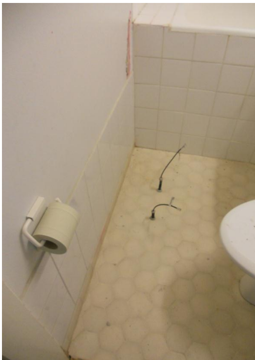
Kuva 47. Pesuhuoneiden kosteuksia mitattiin kahdesta huoneistosta eri puolelta taloa.
