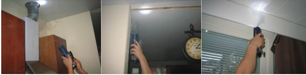
KUVA 13. Vuotokohtien etsintä merkkauusavulaitteella
