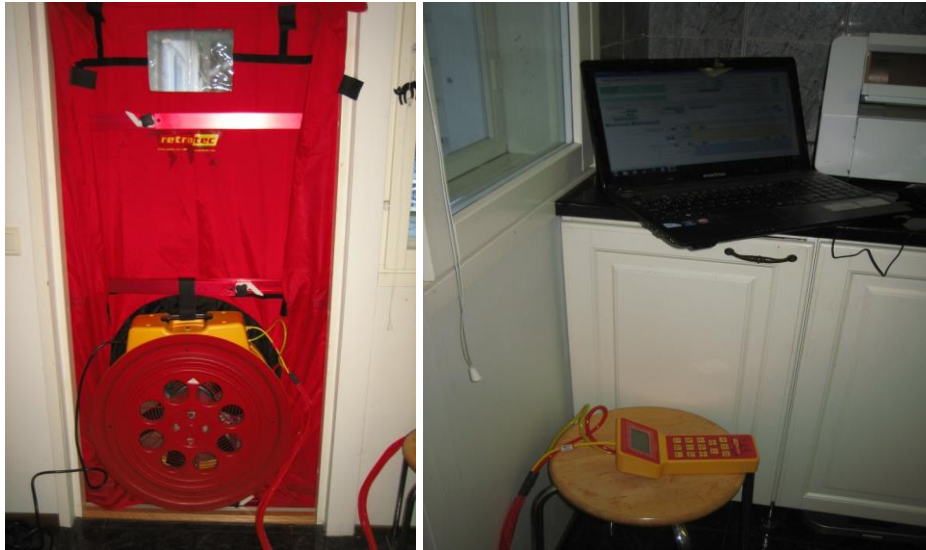
KUVA 12. Alkutiivistykset on tehty ja laitteisto on valmiina tiiviysmittaukseen
