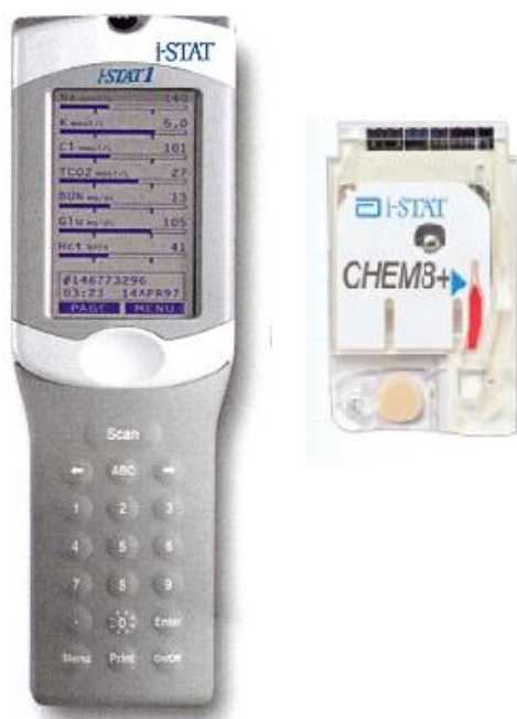
KUVA 2. i-STAT - vieritestausanalysaattori ja CHEM 8+ - näytekasetti (Abbott Point of Care 2008–2012)
