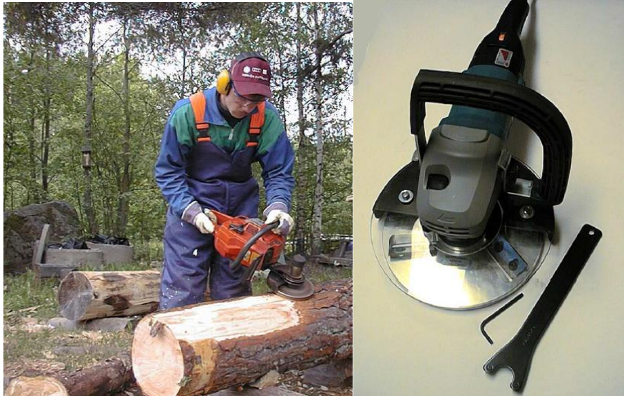
Kuva 6. Vasemmalla: Vuolu-kalle on moottorisahan laippakiinnikkeisiin asennettava kuorintalaite. Oikealla: Vuoluville on sähkömoottorikäyttöinen kuorintakone. Kuvat: Hirsiperinnekeskus.
