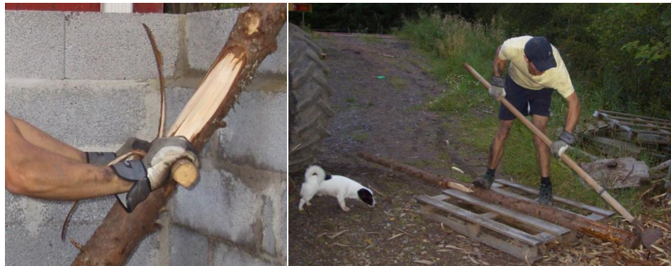
Kuva 8. Poikittaispuun kuorintaa. Vasen kuva kuorimarauta, oikea kuva petkele.
