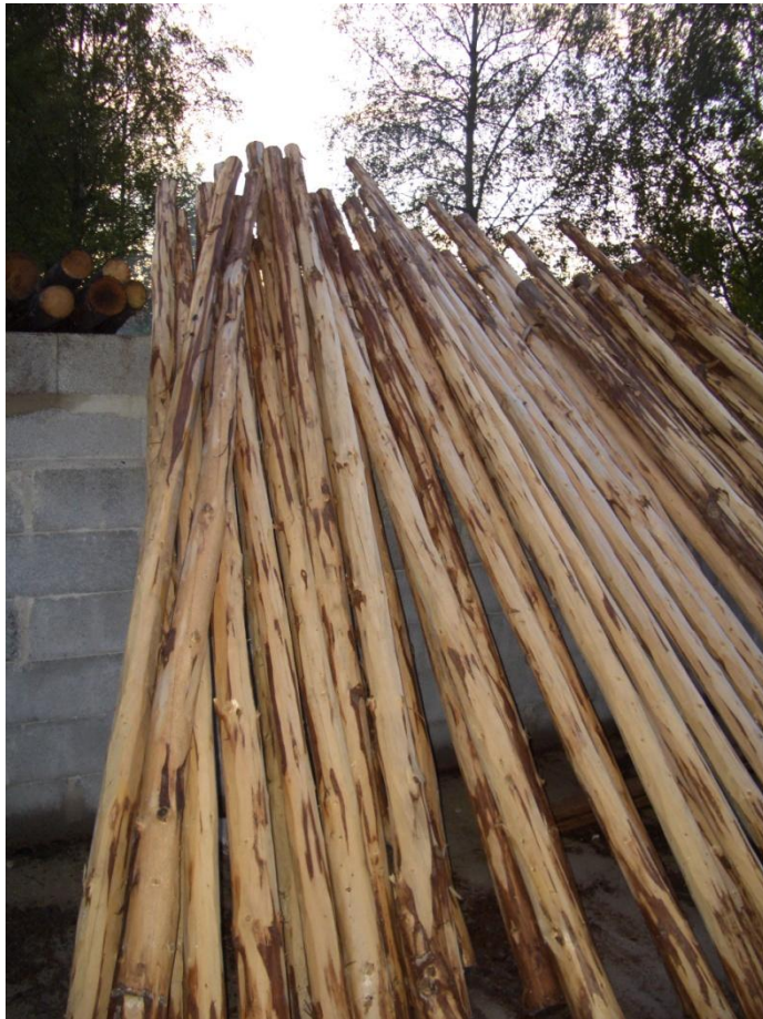
Kuva 4. Erä kuorittuja mutta suojaamattomia poikkitaipuita kuusesta.
