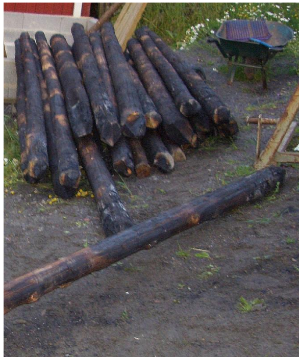
Kuva 10. Polttamalla suojattuja tolppia. Osassa vielä riittämätön hiillos tyvessä. Sateiden myötä tolpat vaalenevat huomattavasti, mutta maan sisään menevän osuuden tarvitsee olla mustaksi hiilletty.
