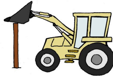
Kuva 21. Tolpat saa painettua syväälle tiiviisti etukuormaajatraktorilla.
