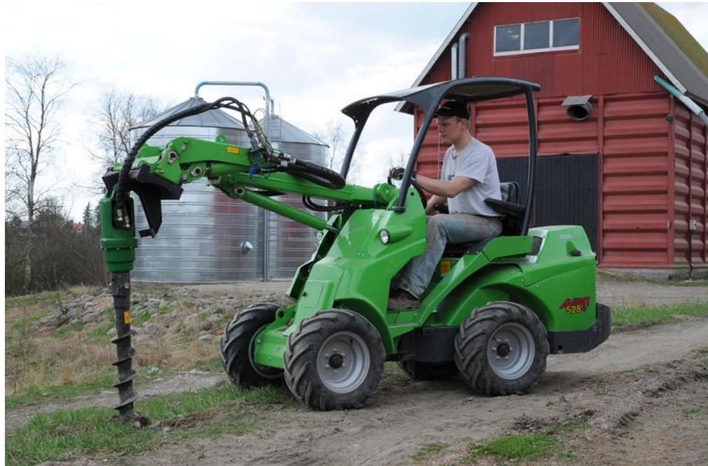
Kuva 17. Pienkuormaaja varustettuna maaporalla on ammattilaisen valinta. HD 35 – soviteosa ja 150mm porapää maksavat n. 3200 € sisältäen arvonlisäveron (Avant). Kuva: Avant.
