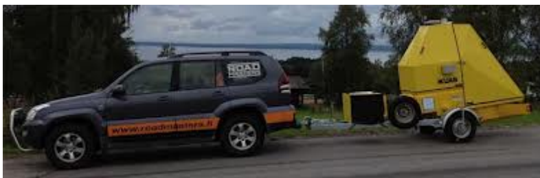
Kuva 3. Kevyt perävaunuun rakennettu pudotuspainolaite (Kuva: roadmasters).
