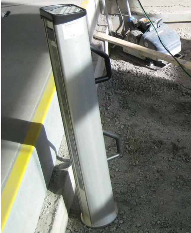
Kuva 4. Kannettava pudotuspainolaite kuvassa vasemmalla (Kuva: Mikko Asunen 2012)
