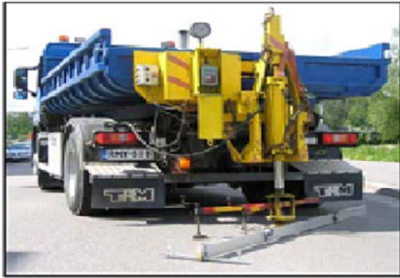
Kuva 2. Levykuormitus koe, kuorma-auto vastapainona (Kuva: Kulmala Hannele 2009)
