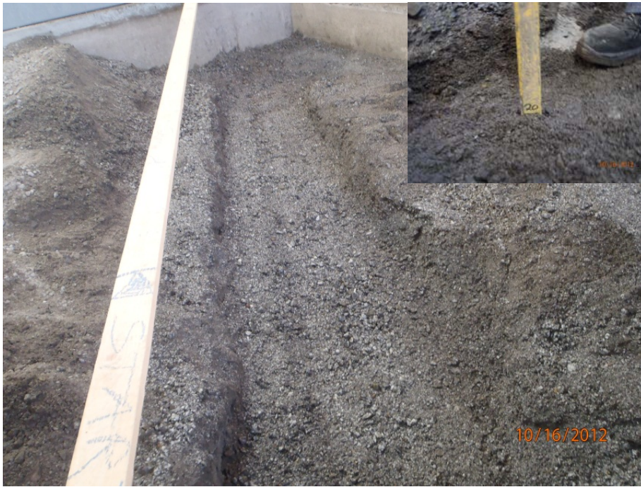
Kuva 16. Koeajorata ennen testin aloittamista ja pikkukuvassa on mittalaite kerrosvahvuuden mittaamiseen (Kuva: Mikko Asunen 2012).
