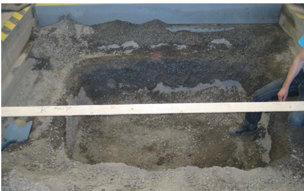
Kuva 6. Alkuperäinen idea koemontusta, jolloin kokeessa tärylätettä pidettäisiin paikallaan (Kuva: Mikko Asunen 2012).
