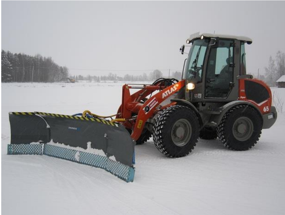
Kuva 2. Atlas AR65S pyöräkuormaaja lumityövarustuksessa.
