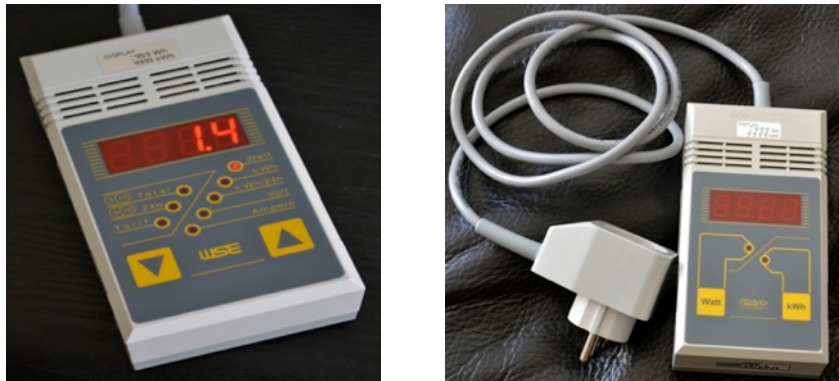
Kuva 11. Sähkönkulutusmittarit LVM210 ja CLM200
