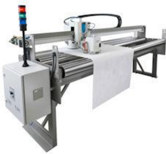
KUVA 3. Textest FX 3500 Combiscan ilmanläpäisyalaite (Textest Instruments 2011)
