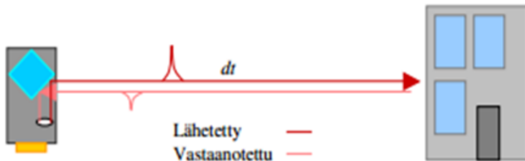
Kuvio 2. Pulssilaserin toimintaperiaate. (Kukko, 2005)
