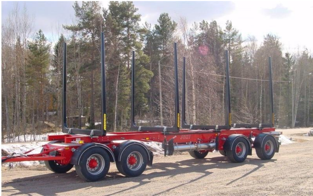
KUVA 4. Kevyt siirto-käyttöön tarkoitettu puutavaraperävaunu (Jyki Oy).
