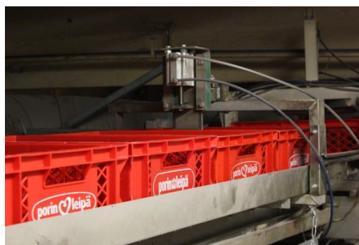
Kuva 13 Pysäytin ennen sämpylälinjan risteystä
