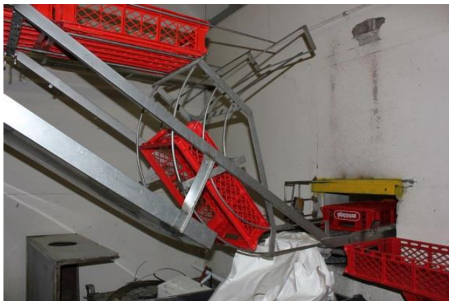
Kuva 9 Kääntökouru ja läpivienti
