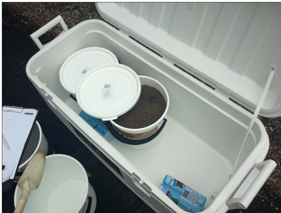
KUVA 8. Maanäytteet otettiin 10 litran sankkoihin ja toimitettiin laboratorioon. Kuva Tervo 11.7.2012.
