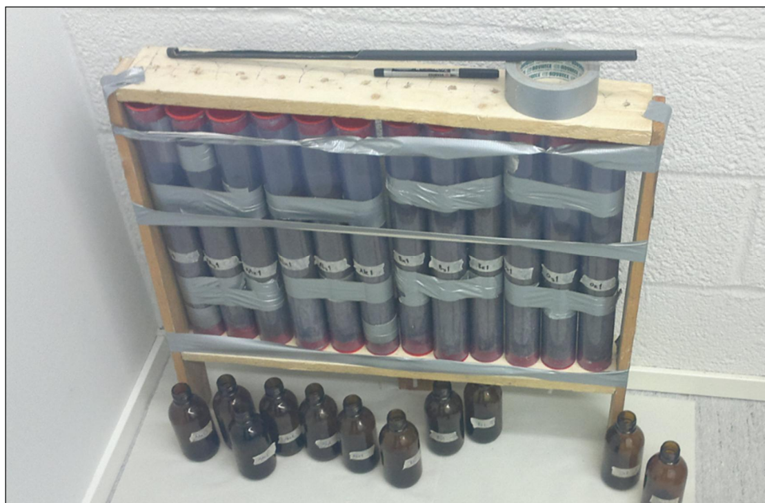
KUVA 9. Pilotointimallinnus rakennettiin PCV-putkista. Putkien sisään mitattiin pilaantunutta maata 400 ml. Kuvassa olevan huoneen ilman lämpötila oli + 5°C. Kuva Tervo 12.9.2012.
