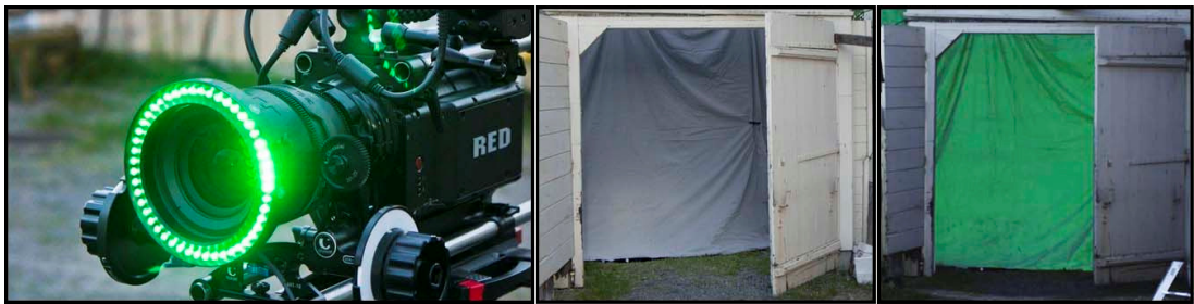
Kuva 2. Ledirengas kamerassa (vasemmalla), Chromatte-kangas paljain silmin (keskellä) ja kameran läpi katsottuna (oikealla)
