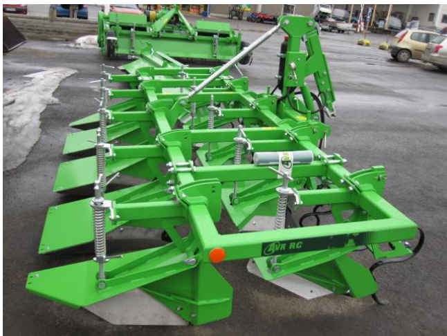
Figur 3. Kupare, AVR, med bänkformat plogande aggregat även med möjlighet till körning i växande bestånd eftersom möjlighet till avmontering av formens tak finns. (Farmers to farmers u.å.)
