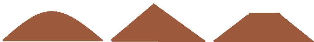
Figur 2. Olika typ av bänkform efter sättningsdjup. Tillpackad efter uppkupning, orörd efter uppkupning och utjämnning av topp efter uppkupning. (Berg 2013)
