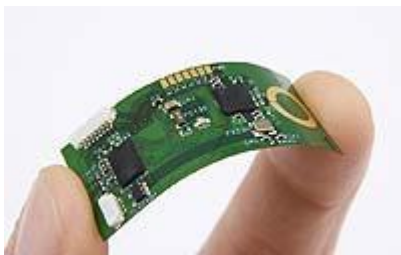
Kuvio 11: Esitelty prototyyppi mittaa sydämen lyöntitiheyttä ja lihasaktiiviteettia (Ojanperä 2009).
