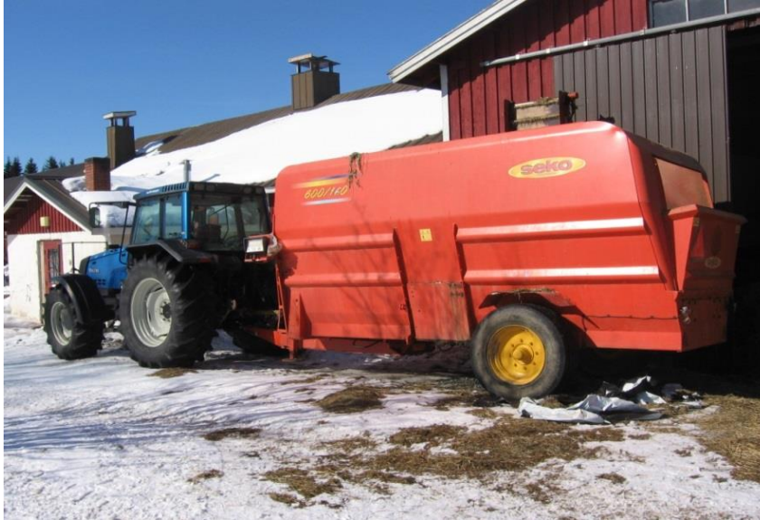
KUVA 2. Traktorivetoinen seosrehuvaunu. Valokuva Tuomas Hyvönen 2013.
