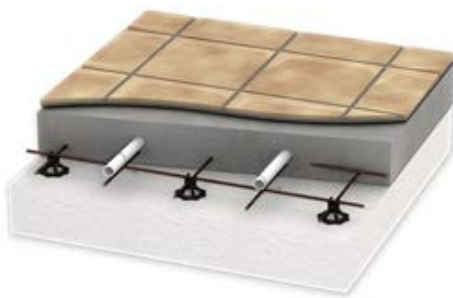
Kuva 9 Putket raudoiteverkossa kiinni. [7.]
