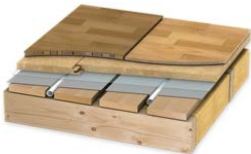
Kuva 12 Putket harvalaudoituksen välissä. [8]
