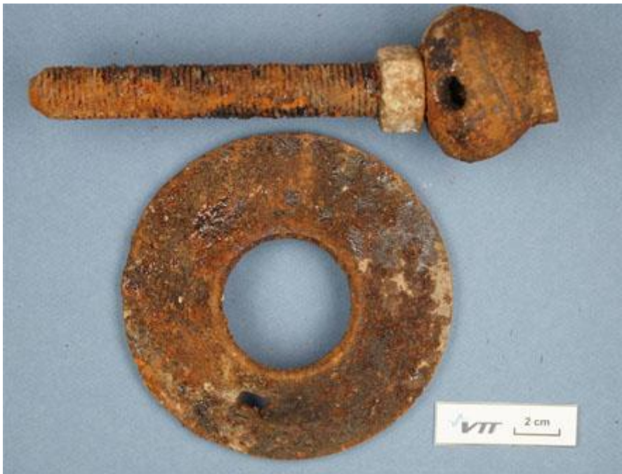
Kuva 5. Vuoden vanha kallioankkurin pää aluslevyineen [13]
