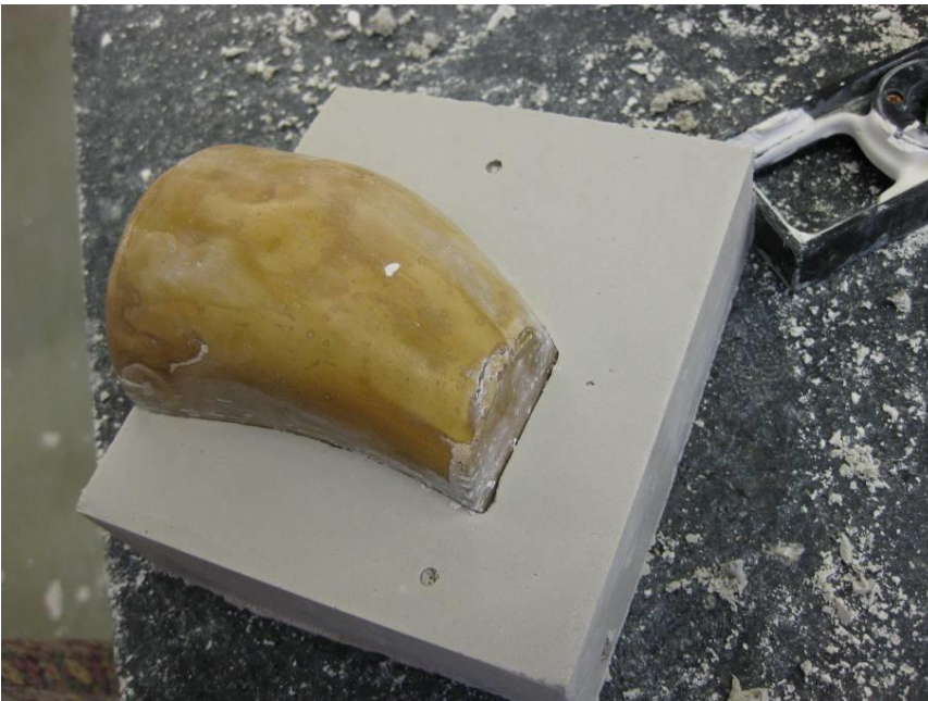
Kuva 20. Apumuotti valmiina jatkotyöstöön.
