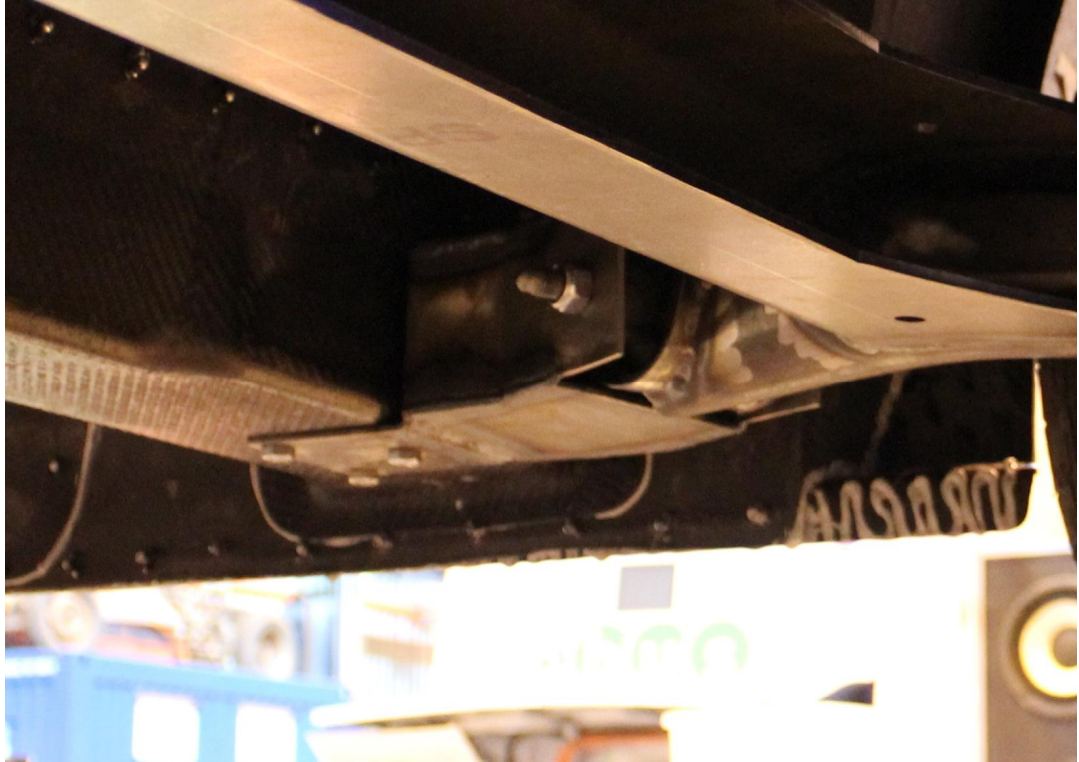
Kuva 27. Taka-akselin kiinnitys auton koriin puslan välityksellä
