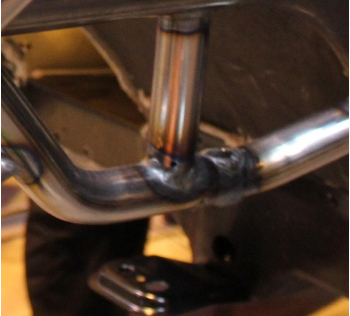
Kuva 11. Eturungon alin tukiputki ja siihen porattu reikä
