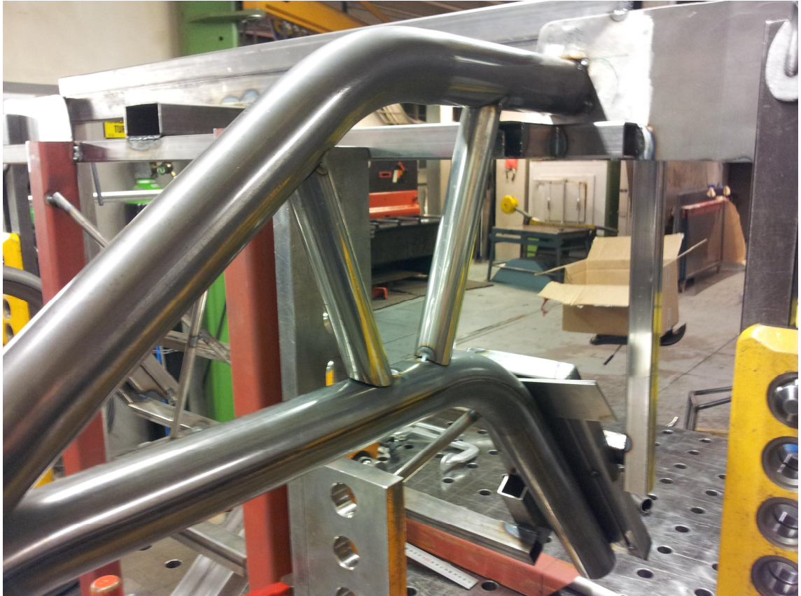
Kuva 10. Eturungon putkia ennen täyssauvoja
