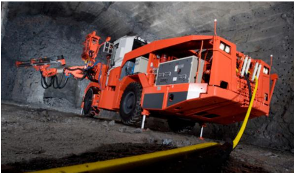
KUVA 4. Rumpukaapeli (DT series 2013)
