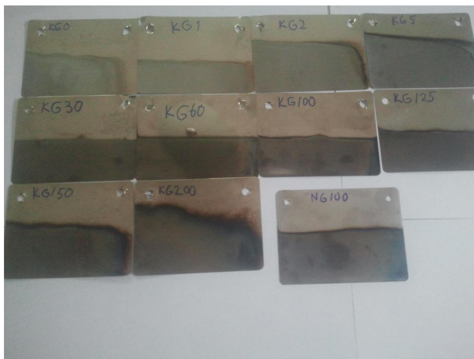
KUVA 9. TC Graphite Make Up -lisäaineen vaikutus pinnoitteisiin (valokuva, Jarno Kinnunen 2013)
