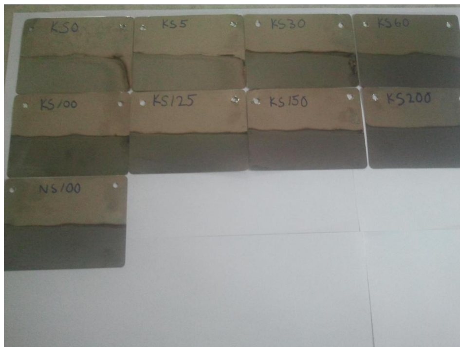
KUVA 10. TC Shadow Make Up -lisäaineen vaikutus pinnoitteisiin (valokuva, Jarno Kinnunen 2013)
