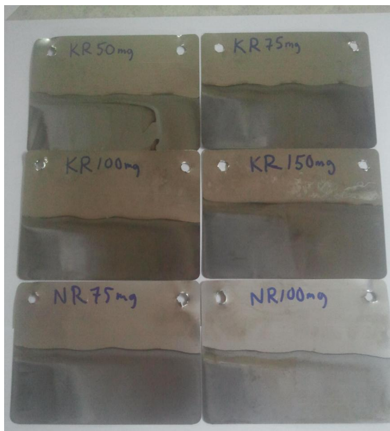
KUVA 13. Kylpyyn liuenneen raudan määrän vaikutus pinnoitteisiin (valokuva, Jarno Kinnunen 2013)
