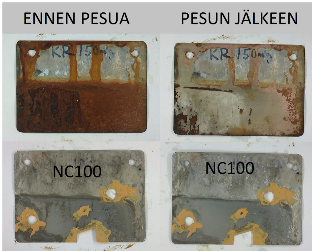
KUVA 19. Kappaleet KR150mg ja NC100 330 h korroosiotestin jälkeen
