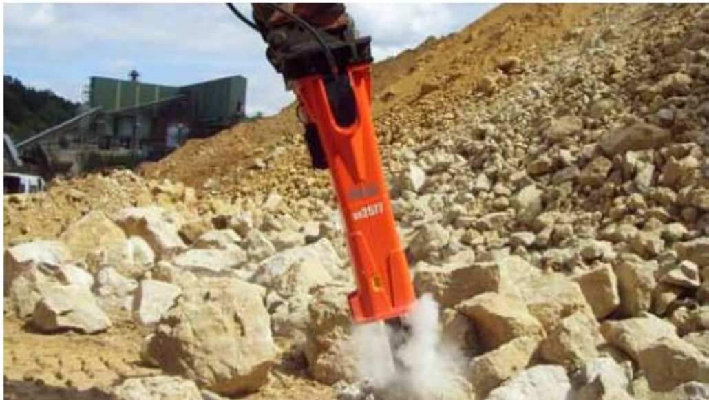
Kuva 1. Hydraulinen vasara toiminnassa (Sandvik 2011, 2)
