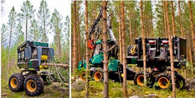
Kuva 9. Fixteri-paalaus kone ja Fixteri asennettuna Logmannin peruskoneeseen. (Kuva: Fixteri Oy 2013)
