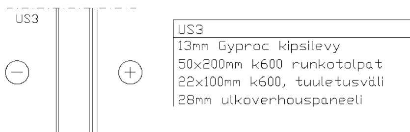
Kuva 19. Varaston ja autokatoksen välinen seinärakenne.
