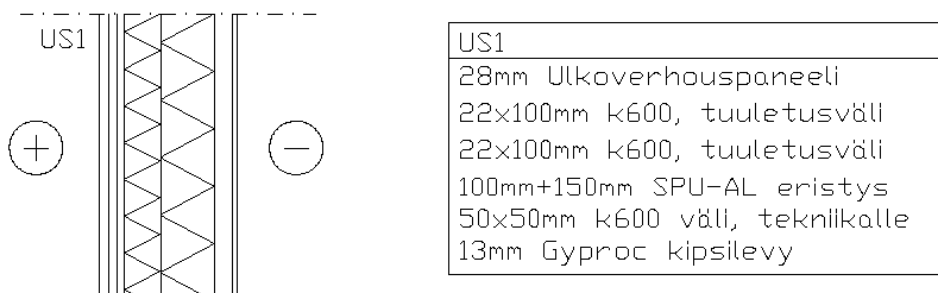
Kuva 17. Lämpimien tilojen seinärakenne.
