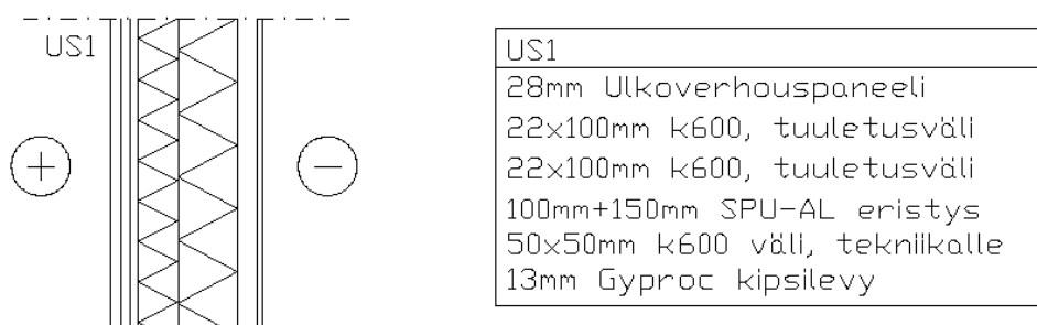
Kuva 38. Puutalon ulkoseinärakenne US1.
