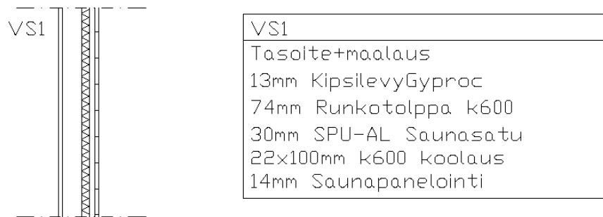
Kuva 20. Makuuhuoneen ja saunan väliseinä.
