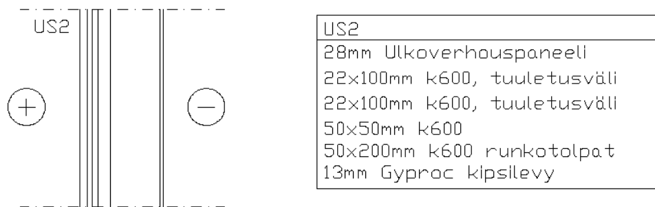
Kuva 18. Varaston seinärakenne.
