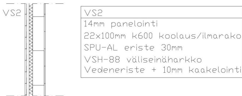
Kuva 10. Saunan ja pesuhuoneen väliseinä.
