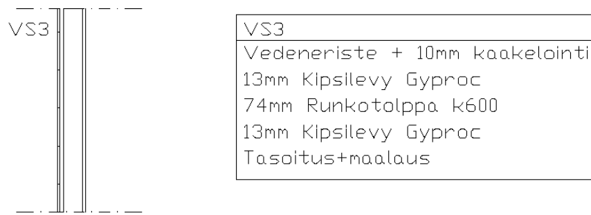
Kuva 22. Pesuhuoneen ja kodinhoituhuoneen väliseinä.
