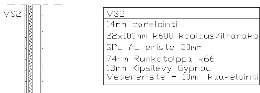
Kuva 21. Saunan ja pesuhuoneen väliseinä.
