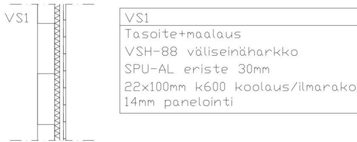
Kuva 9. Makuuhuoneen ja saunan väliseinä.
