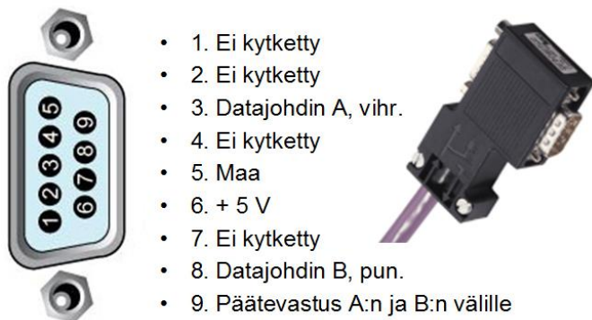
KUVA 14. 9-napaisen D-liittimen kytkentäohje ja PG-liitin, eli läpiviennillinen D-liitin (20, s. 10)
