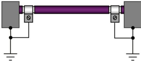
KUVA 15. Molemmista päistä maadoitettu Profibus-kaapeli (18, s. 166)
