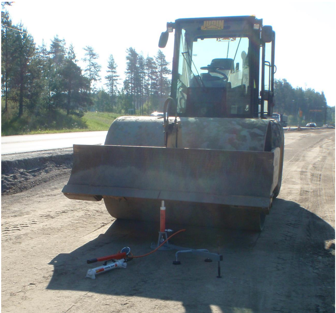
Kuva 4. Yhdellä mitta-anturilla varustettu levykuormituslaitteisto
