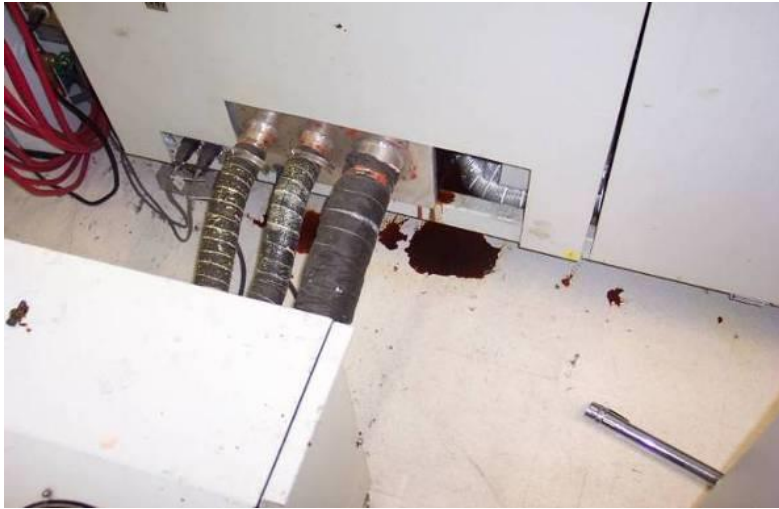
KUVA 5. Öljyvuodon erottuminen muuten siistissä ympäristössä
